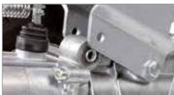
Manillar montado sobre soportes antivibración.
