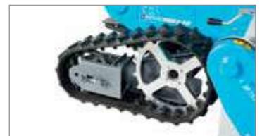
El sistema de tracción con orugas oscilantes se adapta a los distintos tipos de terreno.
