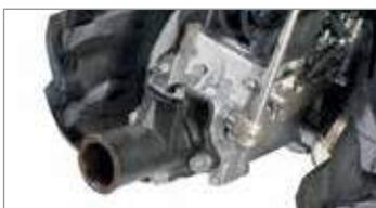
Conexión rápida QuickFit integrada que permite cambiar el equipo de trabajo sin herramientas.
