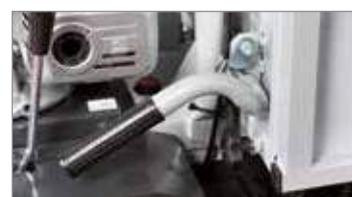
Basculamiento manual con sistema de bloqueo automático.
